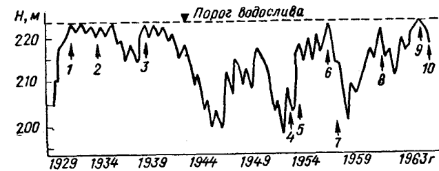
Рис. XII-14. Колебания уровня воды в водохранилище Марафон. Стрелками показаны землетрясения с магнитудой 6 и более.
