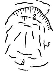
Рис. IX-9. Расположение наиболее характерных трещин на оползневом участке.
