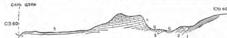
Ф и г. 32. Разрез к юго-востоку от Чаная, в северном Гуанси, показывающий несогласное залегание девонских отложений на ордовикских, связанное с каледонскими движениями. (По Ли.)
