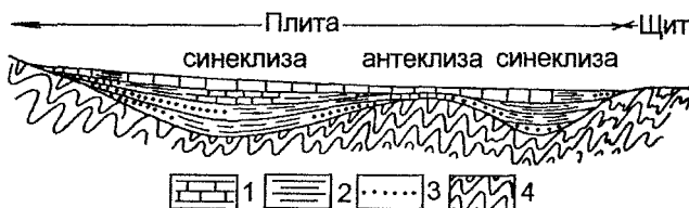
Рис. 3.2. Строение платформ. Осадочный чехол: 1 – известняки, 2 – сланцы, 3 – песчаники, 4 – складчатые породы фундамента
