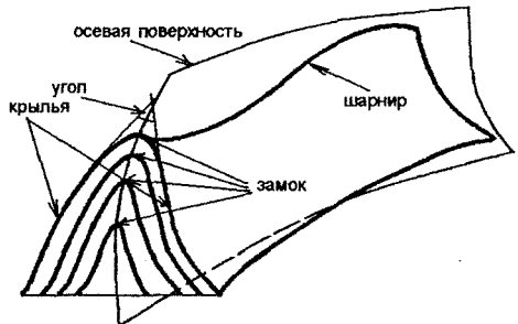
Рис. п.12.1. Элементы складки
