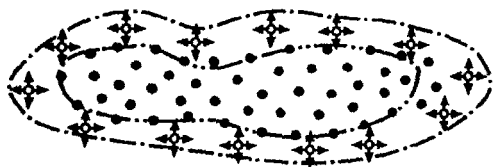
Рис. п.33.2. Система разработки нефтяной залежи с приконтурным заводнением (по М.М.Ивановой и др., 2000). Условные знаки см. на рис. п.33.1
