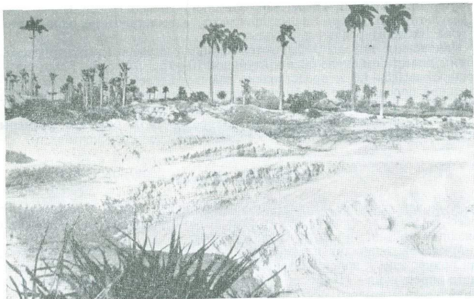
Фиг. 6. Карьер полевошпатового месторождения Сабоней-де-Пурнео в провинции Ориенте, разрабатывающий слабо каолинизированные риолиты нижнемелового возраста
