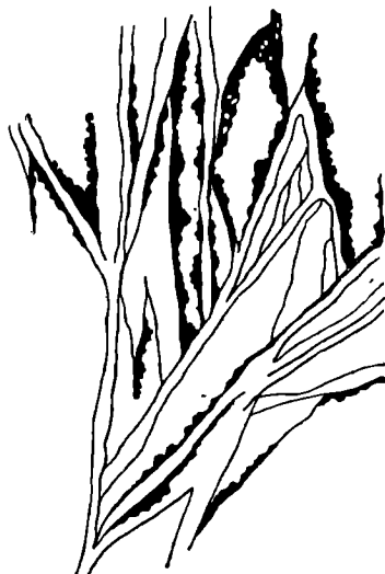
Рис. 216. Фрагмент алмазно-пестельчатой текстуры лимонита по галениту. Увел. 4
