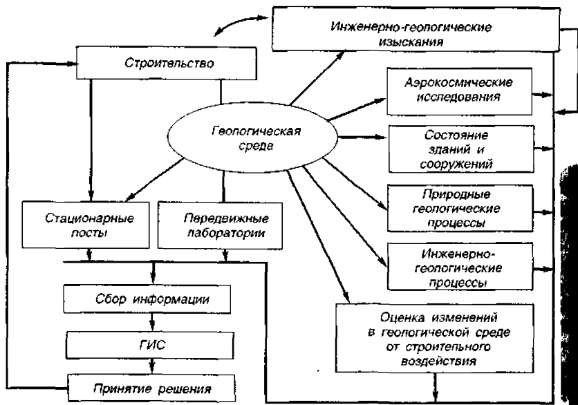
Р и с . 166. Функциональная схема геоинформационной системы оценки влияния строительства на геологическую среду
