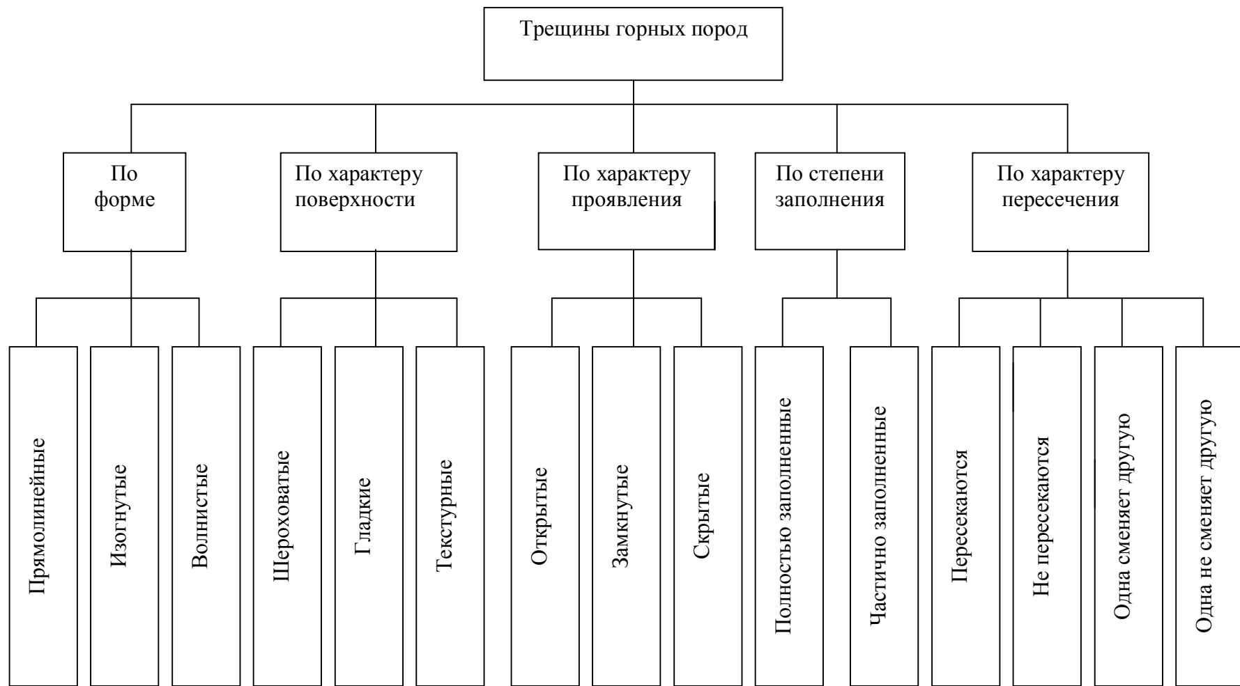
Рисунок-3.8-. Морфологический вид трещин
