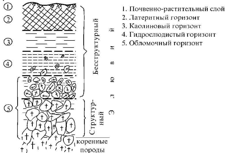
Рис. 7. Обобщенный разрез элювиальной составляющей коры выветривания полного профиля (теоретический вариант)
