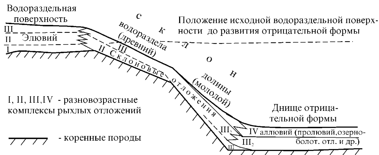
Рис. 3. Схема сочленения элементарных поверхностей и связанных с ними генетических типов рыхлых отложений в условном ландшафте
