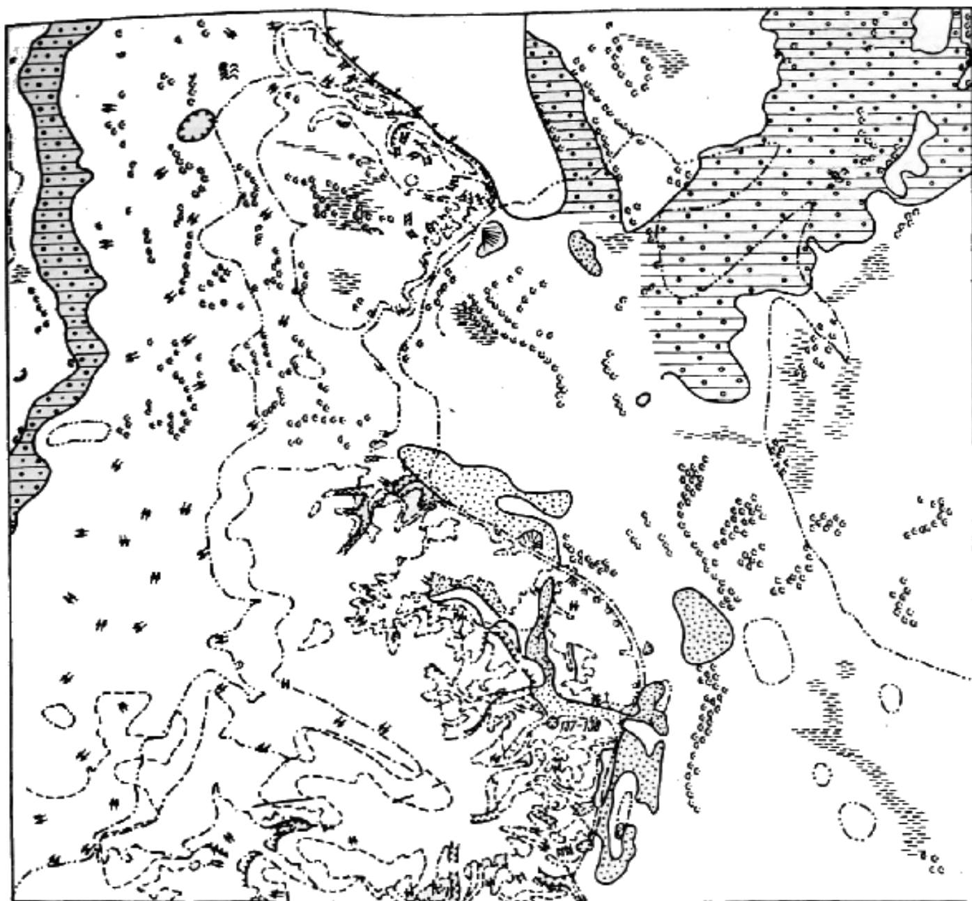
Рис. 42. Схематическая карта современных экзогенных процессов: 1 - интенсивный разрыв в верховьях оврагов и балок; 2 - аккумуляция в устьях оврагов и балок; 3 - донная и боковая эрозия в речных долинах и балках; 4 - аккумуляция в речных долинах (а - участки техногенного преобразования пойменных террас, где естественные процессы зарегулированы); 5 - поверхностный смыв и делювиальные процессы; 6 - развезание и навезание песков; 7 - процессы заболачивания; 8 - абразионные процессы; 9 - искусственная денудация; 10 - искусственная аккумуляция; 11 - контуры распространения лесовых пород; 12 - контуры распространения красно-бурых и пестрых глин; 13 - контуры распространения полтавской свиты; 14 - контуры распространения киевских мергелей
