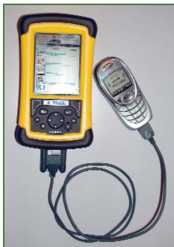
Рис. 5 Передача данных в стандарте GSM/GPRS
