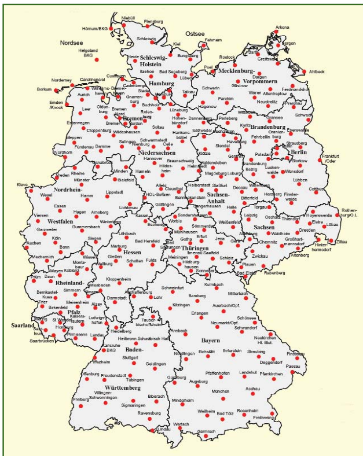
Рис. 2 Расположение базовых станций SAPOS (на январь 2004 г.)
