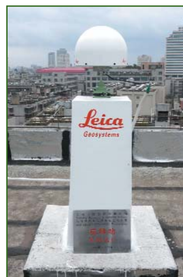
Рис. 2 Крепление антенны спутникового приемника на железобетонном пилоне
