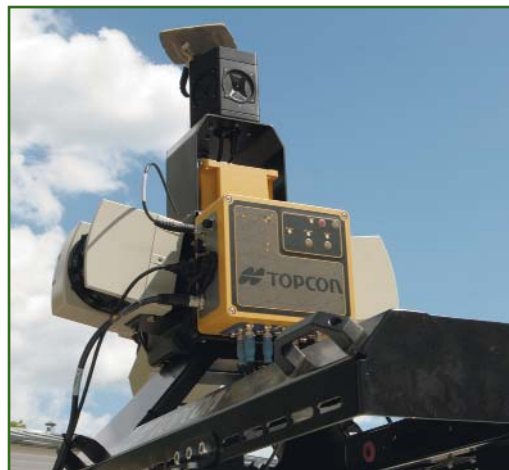
Рис. 2 Общий вид блока управления системы IP-S2 с датчиками измерений
