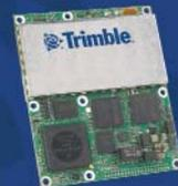
компактный ГНСС приемник с обработкой сигнала от двух антенн определяет точные координаты и элементы ориентации, что позволяет решать сложные задачи управления
