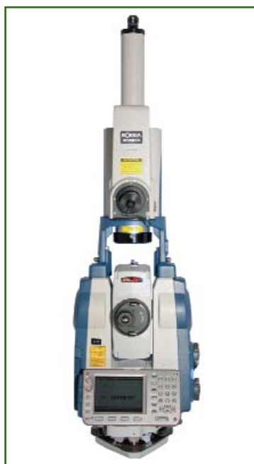
Рис. 2 Гиристанция GYRO X, установленная на тахеометре
