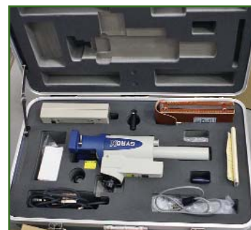
Рис. 3 Гиристанция GYRO X и ее комплектующие в специальном кейсе
