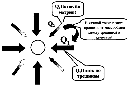
Рис. 4.4.2.2. Схема массопереноса в среде двойной пористости.
