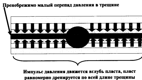
Рис. 4.3.2.4. Линейный режим течения в пласте.
