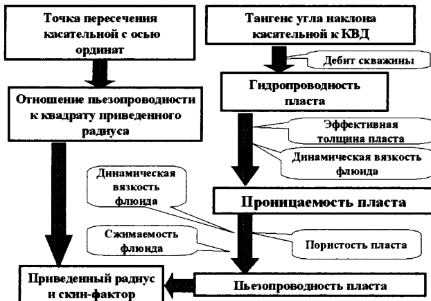
Рис. 6.3.2.1. Оценка фильтрационных параметров пласта при обработке КВД (КСД) асимптотическим методом.
