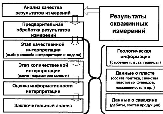
Рис. 6.1.0.1. Этапы работы с информацией ГДИС при обработке и интерпретации.
