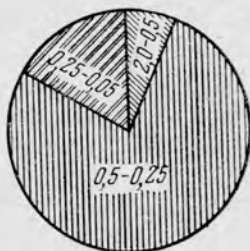
Рис. 8. Циклограмма гранулометрического состава породы
