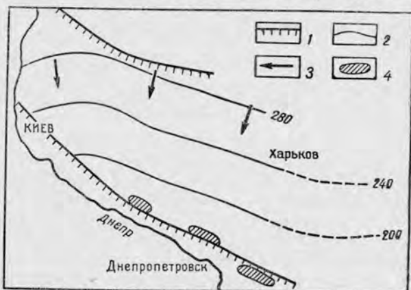
Рис. 72. Схема гидроизопьез средне-верхнекаменноугольного комплекса Днепровско-Донецкого бассейна (по Л. П. Швай)
