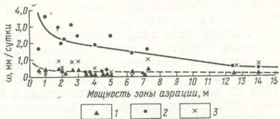
Рис. 58. Зависимость интенсивности инфильтрационного питания от мощности зоны аэрации. 1 — за год; 2 — весной; 3 — осенью
