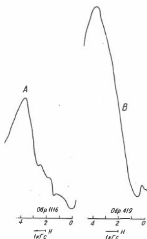
Рис.2. Спектры ЭПР ионов \text{Fe}^{3+} в ортопироксенах со слабым (А) и сильным (В) искажением линий, вследствие присутствия в образцах тонкодисперсной механической примеси окислов железа
