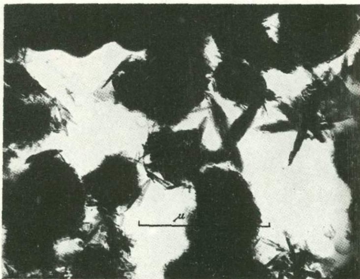
Фиг. 69. Гематит (дисковидные выделения) и гетит (удлиненные кристаллиты и их сростки) из латеритной коры выветривания
