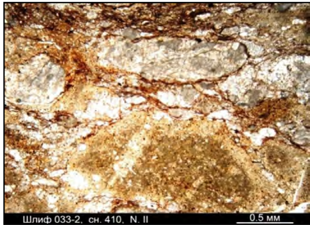
Рис. 4.1.16. Шлиф 033-2, снимок 410, ник. II. В нижней части – обломок гидрослюдистого материала, осветлённый с поверхности
