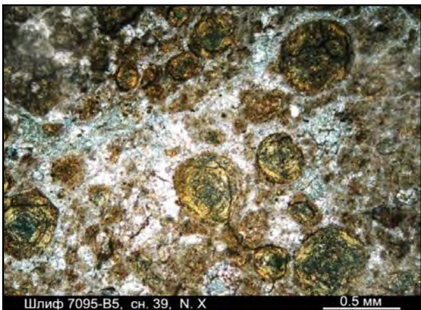
Рис. 4.2.125. Шлиф 7095-B5, снимок 39, ник. X. В поляризованном свете в «оолитах» заметны крестообразные фигуры погасания
