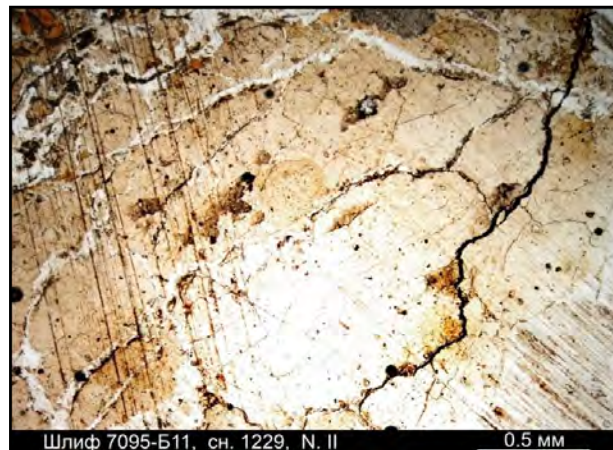
Рис. 4.2.86. Шлиф 7095-Б11, снимок 1229, ник. II. В проходящем свете гидрослюдистый материал выглядит однородным
