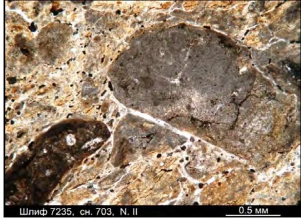
Рис. 4.10.35. Шлиф 7235, снимок 703, ник. II. Один из обломков пелитоморфного известняка рассечён со смещением трещиной, выполненной карбонатом
