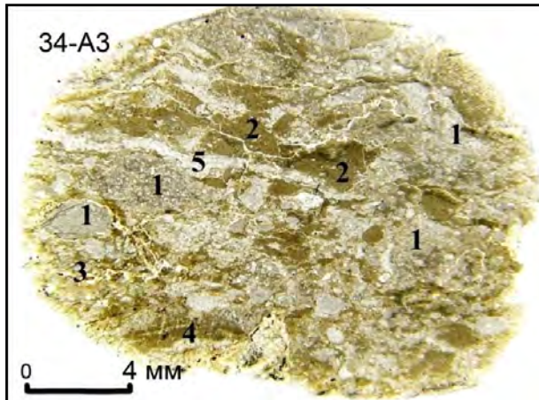
Рис. 4.10.18. Шлиф 7234-A3. То же, в проходящем свете. Брекчия состоит из обломков известняка (1) и гидрослюдистого материала (2) и из микрозернистой связующей массы (3)
