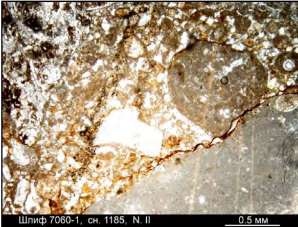
Рис. 4.9.87. Шлиф 7060-1, снимок 1185, ник. II. Два разнородных обломка известняка разделены микропрожилком железистой глины. Контакт напоминает стилолитовый шов: контур одного обломка повторяет контур другого
