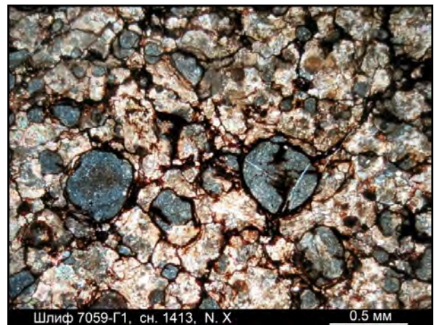
Рис. 4.9.122. Шлиф 7059-Г1, снимок 1413, ник. X. Избирательная карбонатизация основной массы породы; оолитовидные глинистые образования анизотропны
