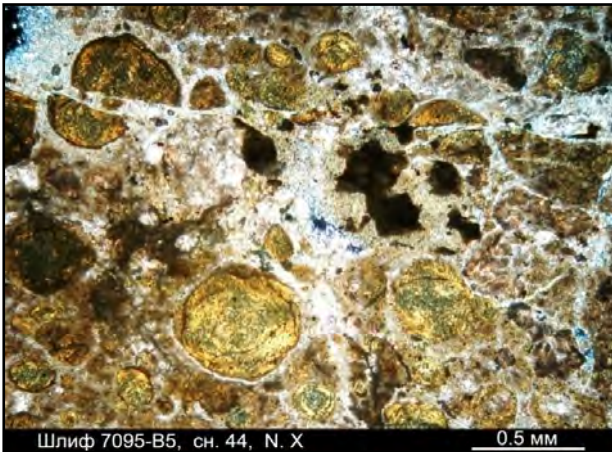
Рис. 4.2.127. Шлиф 7095-B5, снимок 44, ник. X. В оолитовидных образованиях – крестообразные фигуры погасания. Два «оолита» рассечены со смещением карбонатным прожилком
