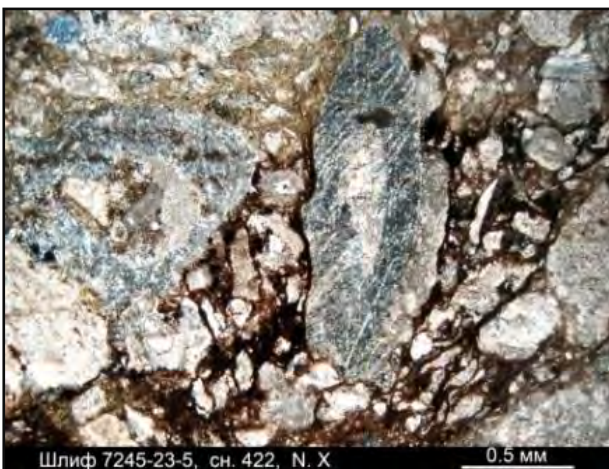
Рис. 4.9.68. Шлиф 7245-23-5, снимок 422, ник. X. Фрагмент гидрослюдисто-карбонатной брекчии, обогащённой гидроокислами железа. Серое – метакристаллы доломита
