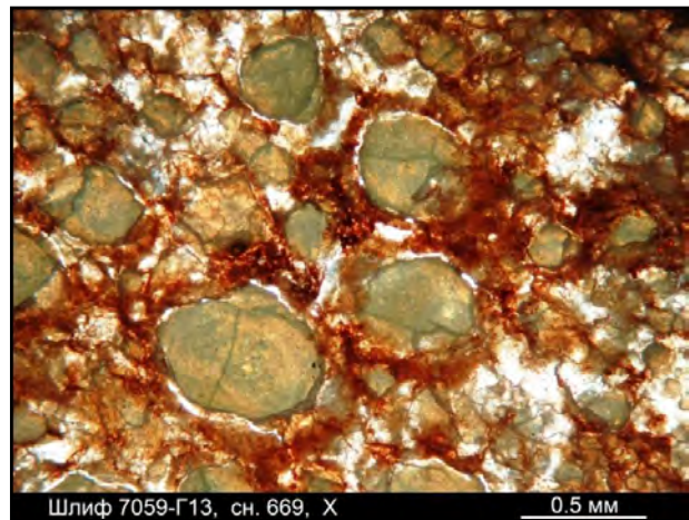
Рис. 4.9.152. Шлиф 7059-Г13, снимок 669, ник. X. Оолитовидные, округло-полигональные зёрна глинисто-гидрослюдистого минерала имеющие скрытокристаллическую, микроволокнистую структуру
