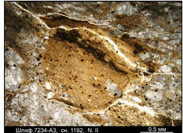
Рис. 4.10.21. Шлиф 7234-A3, снимок 1192, ник. II. Обособление цементирующей массы, по форме более напоминающее обломок
