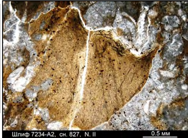
Рис. 4.10.11. Шлиф 7234-A2, снимок 827, ник. II. Обломок однородного гидрослюдистого материала, левая часть которого плавно переходит в связующую массу
