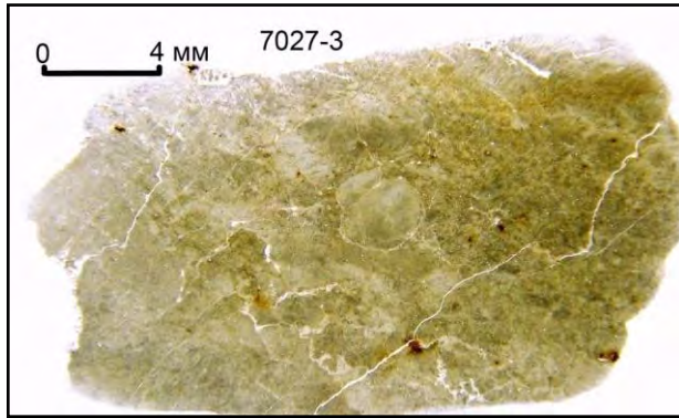
Рис. 4.7.8. Шлиф 7027-3. Массивная, разнообломочная гидрослюдистая порода (брекчия). Обломки – от 3-6 мм до 0,2-0,02 мм (в цементе)
