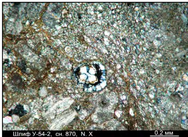
Рис. 4.1.49. Шлиф У-54-2, снимок 870, ник. X. В центре - конкреция халцедона; прожилки гидрослюдистого цемента её огибают
