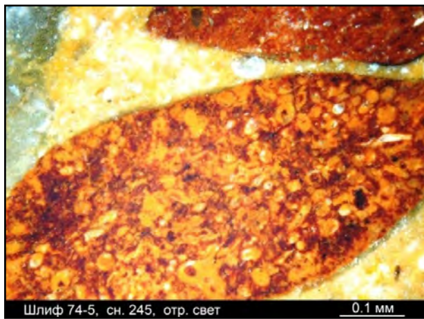
Рис. 4.1.90. Шлиф 7074-5, снимок 245. Фрагмент зерна лимонита в отражённом свете. Зерно состоит из мелких (0.01-0.02 мм) частиц округлой, реже полигональной формы и из микрзернистого базального лимонитового матрикса
