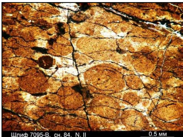
Рис. 4.2.97. Шлиф 7095-В, снимок 84, ник. II. Оолитовидные образования выделяются на фоне карбонатизированной основной массы породы
