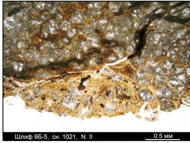
Рис. 4.4.14. Шлиф 9Б-5, снимок 1021, ник. II. В верхней части снимка – брекчия ранней генерации, в нижней – гидрослюдистый цемент брекчии поздней генерации
