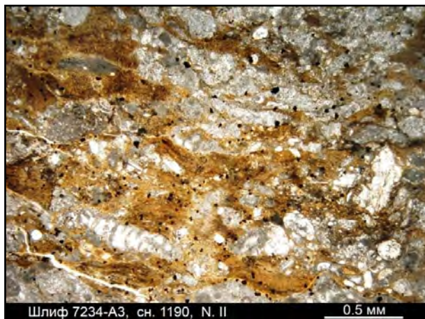
Рис. 4.10.20. Шлиф 7234-A3, снимок 1190, ник. II. Инъецирование известняка прожилками гидрослюдистого материала нередко носит характер пропитки
