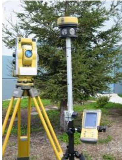
Комплект роботизированного электронного тахеометра *GTS-903A (TOPCON)*
