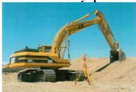
Позволяют выполнять выемку грунта до заданной глубины и уклона с сантиметровой точностью. Возможны три режима работы: с заданным уклоном, с заданной глубиной и комбинированный (с лазерным построителем плоскости). Режим уклона обеспечивает ви-
