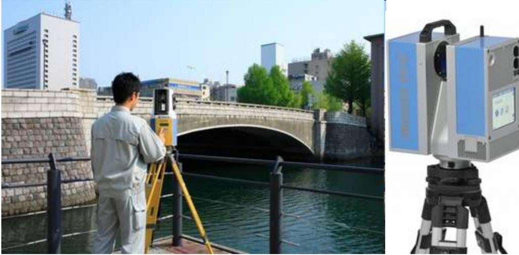
Затем обрабатывают первоначальные данные, полученных со сканера, и подготавливают результаты измерений в том виде, в котором они необходимы заказчику. Данный этап не менее важен, чем проведение полевых работ, и зачастую более трудоемок и сложен. Профили и сечения, плоские планы, трехмерные модели, вычисления площадей и объемов поверхностей – все это, а также другую необходимую информацию можно получить в качестве конечного результата работы со сканером.
