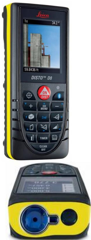
Существуют светодальномеры, использующие диффузное отражение сигнала от предметов и не требующие отражателя. Таким дальномером является лазерная рулетка, например, Disto™ D8 фирмы Leica (Швейцария). Прибор используют без штатива, с руки. Световой луч наводят на нужные объекты и на шкале читают расстояния до 200 м с точностью 1 мм.
