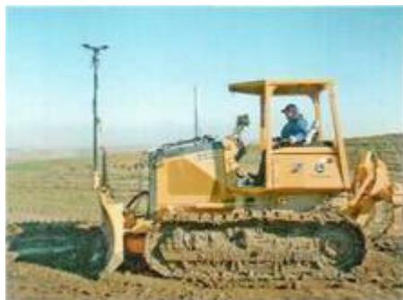
Позволяют выполнять предварительные земляные работы в автоматическом режиме с контролем поперечного уклона и высоты отвала с беспрецедентной точностью  $\pm 2$  см.
