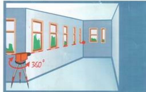
Проверка равновысотности на большом расстоянии
