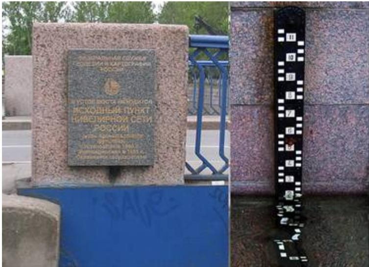
На топографических картах РФ за точку отсчета принято нулевое деление футштока Кронштадтского моста (фото). **Футшток** – это рейка (брус) с делениями, установленная на водомерном посту для наблюдений уровня воды в море, реке или озере. Служит для изучения изменения уровня в данном месте, определения среднего уровня моря (реки) и
