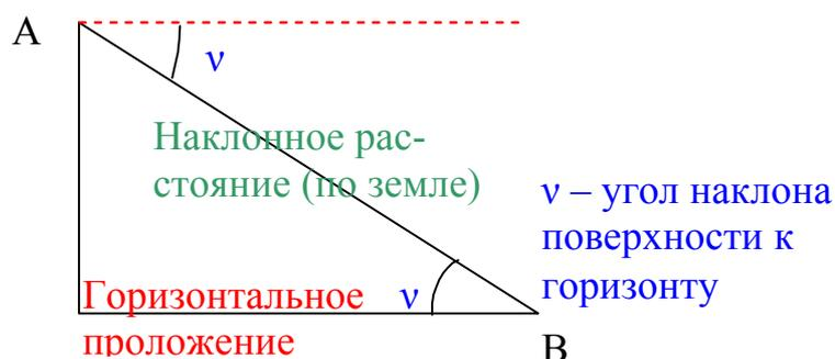
При измерении расстояний применяют непосредственный или косвенный методы измерений. В соответствии с применяемым методом все приборы для измерения расстояний можно разделить на три группы: первая группа относится к непосредственному методу измерения, следующие две – к косвенному.
