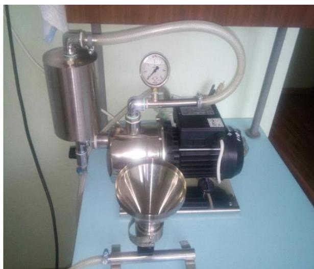
Рис. 32. Прибор для вакуумного фильтрования ПВФ-35
