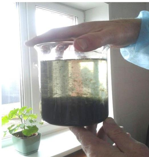
Рис.15. Отделение осадка в виде гидроокисей макро – и микроэлементов при нейтрализации кислотности экстракта шунгита
