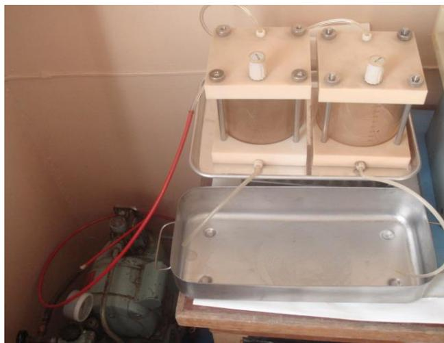
Рис. 9. Модули для микро- и ультраfiltrации типа ФМ02 – 1000
