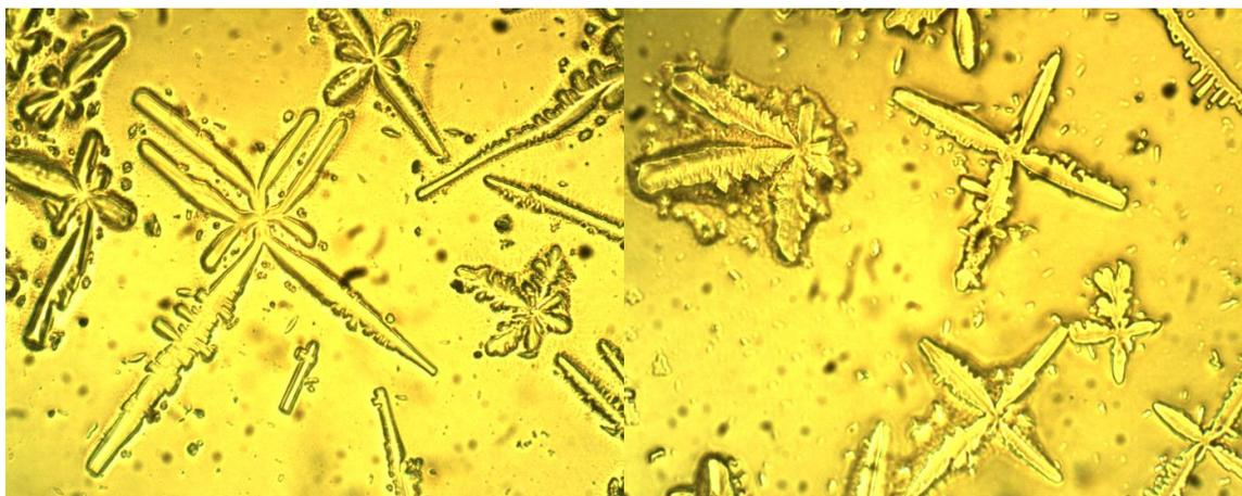
Рис. 22. Морфология кристаллов из экстракта шунгита подвергнутого замораживанию-оттаиванию при температуре  $-20^{\circ}\text{C}$  (pH4,0), x 400
