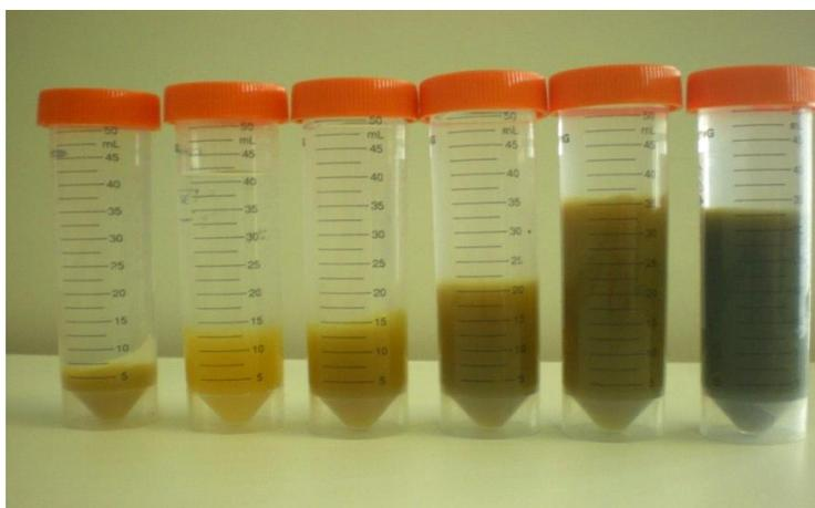
Рис. 14. Тубы с осадками после нейтрализации кислотности водных экстрактов щебня шунгита раствором NaOH
