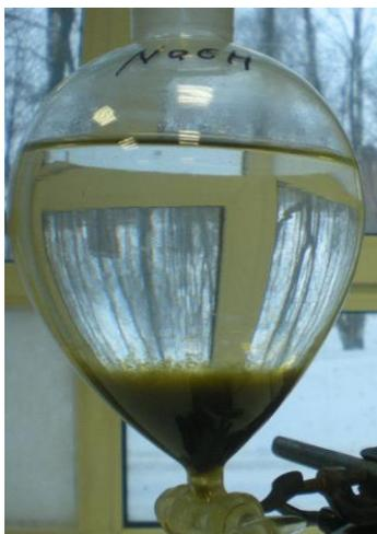
Рис. 13. Отделение взвеси с помощью делительной воронки
