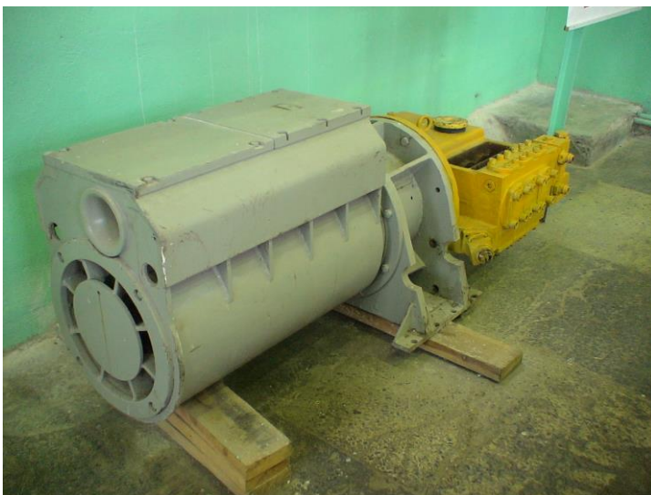
Рисунок 19 – Промышленная маслостанция современных механизированных крепей
