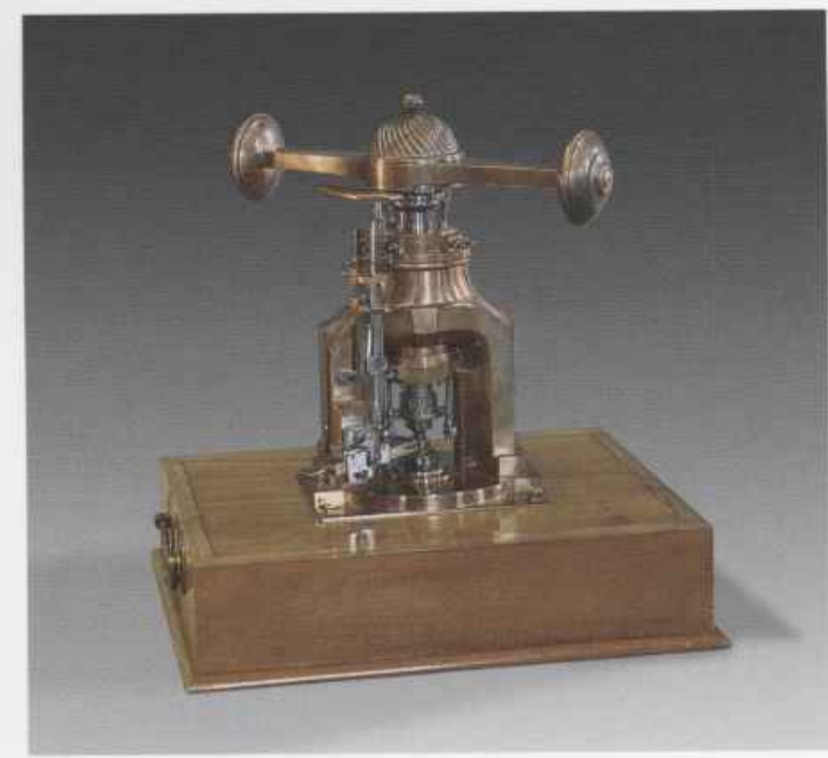
14 ВИНТОВОЙ ПРЕСС ДЛЯ ШТАМПОВАНИЯ МОНЕТ СИСТЕМЫ М. БОУЛТОНА Модель 39 × 37 × 28 см Мастер И. Лизель, Англия, конец XVIII в.
