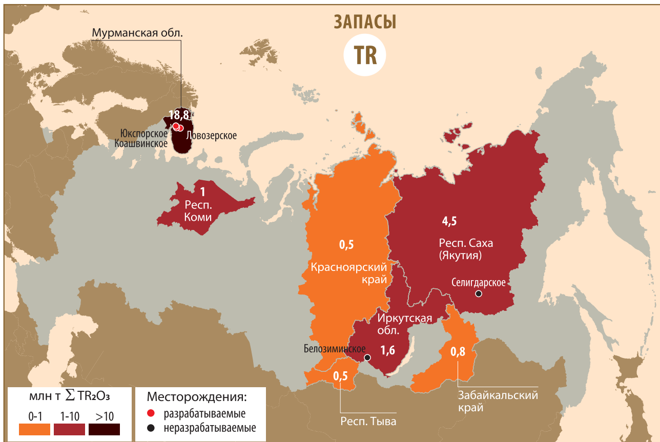
Основные месторождения редкоземельных металлов и распределение их балансовых запасов по субъектам Российской Федерации, млн т в пересчете на сумму триоксидов РЗМ
