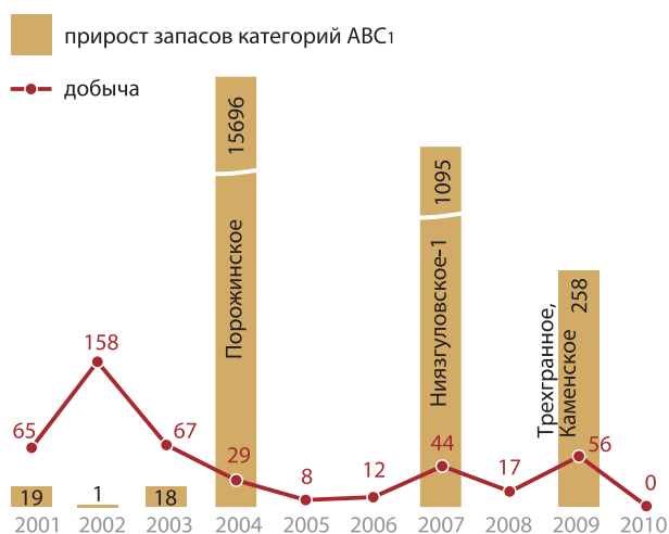
Динамика добычи марганцевых руд и прироста их разведанных запасов в результате ГРП в 2001-2010 гг., тыс. т
