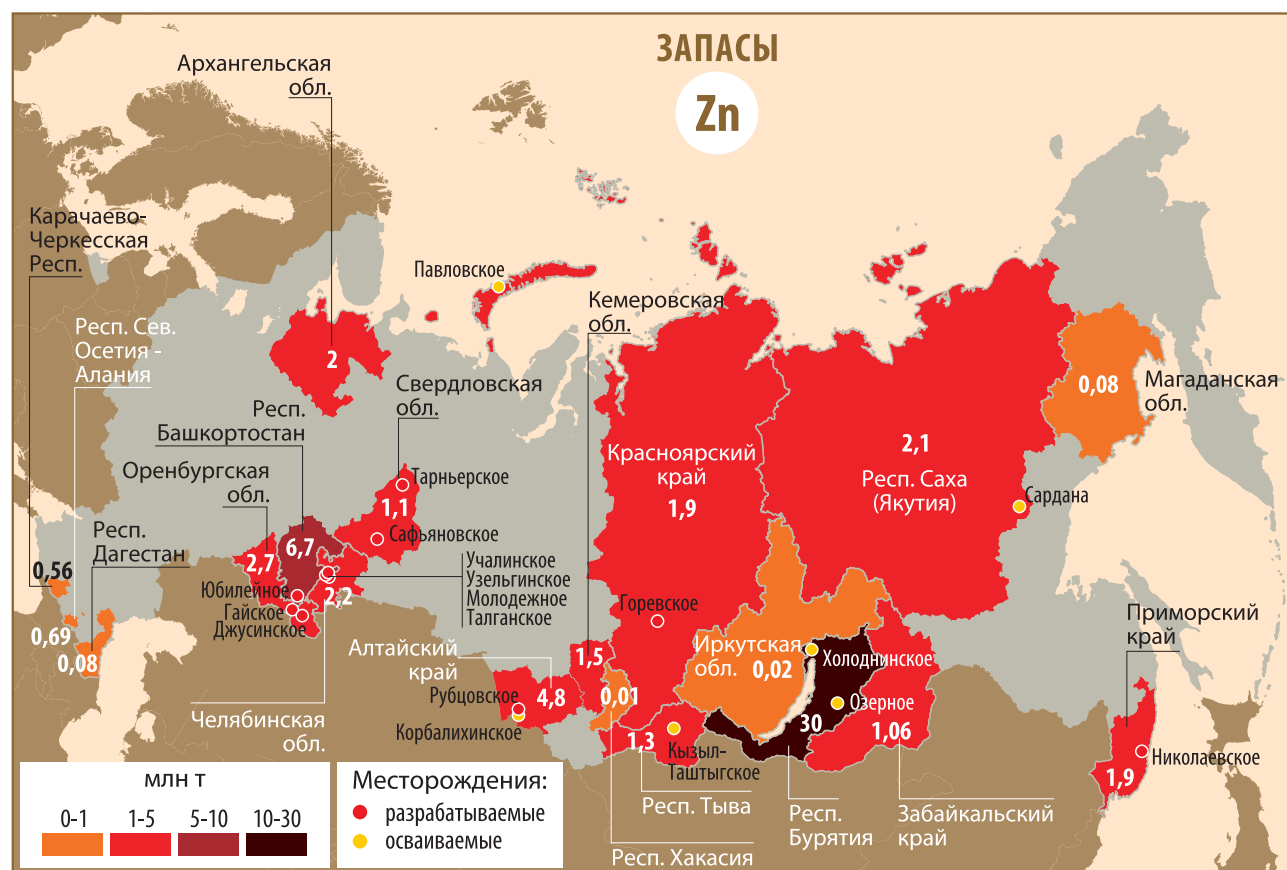
Основные месторождения цинка и распределение его балансовых запасов по субъектам Российской Федерации, млн т
