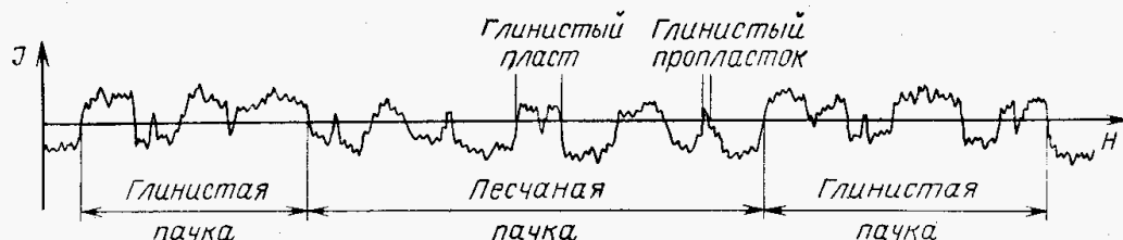
Рис. 37. Расчленение кривой ГК с помощью алгоритма КЧП
