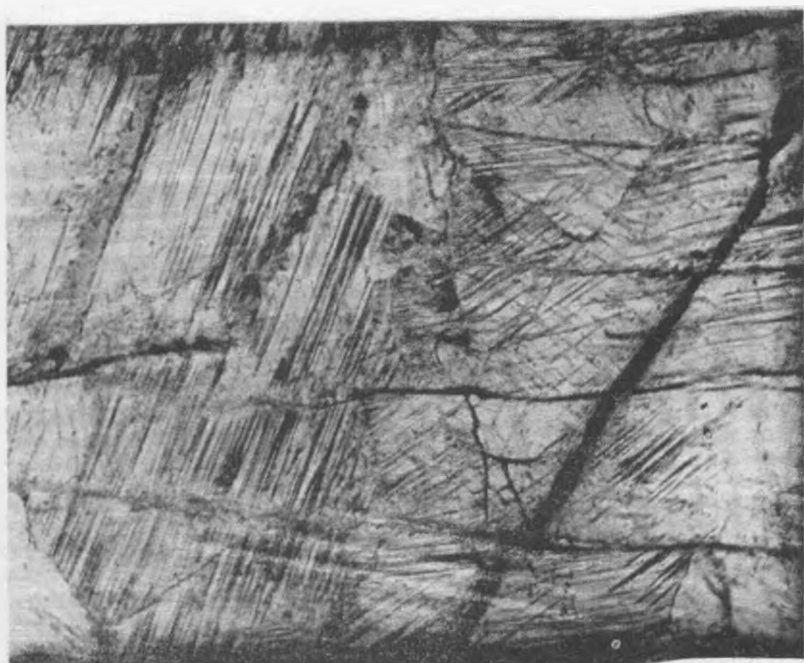
Р и с. 44. Диаплектовый кварц с тремя системами планарных элементов, увел.25, без анализатора
