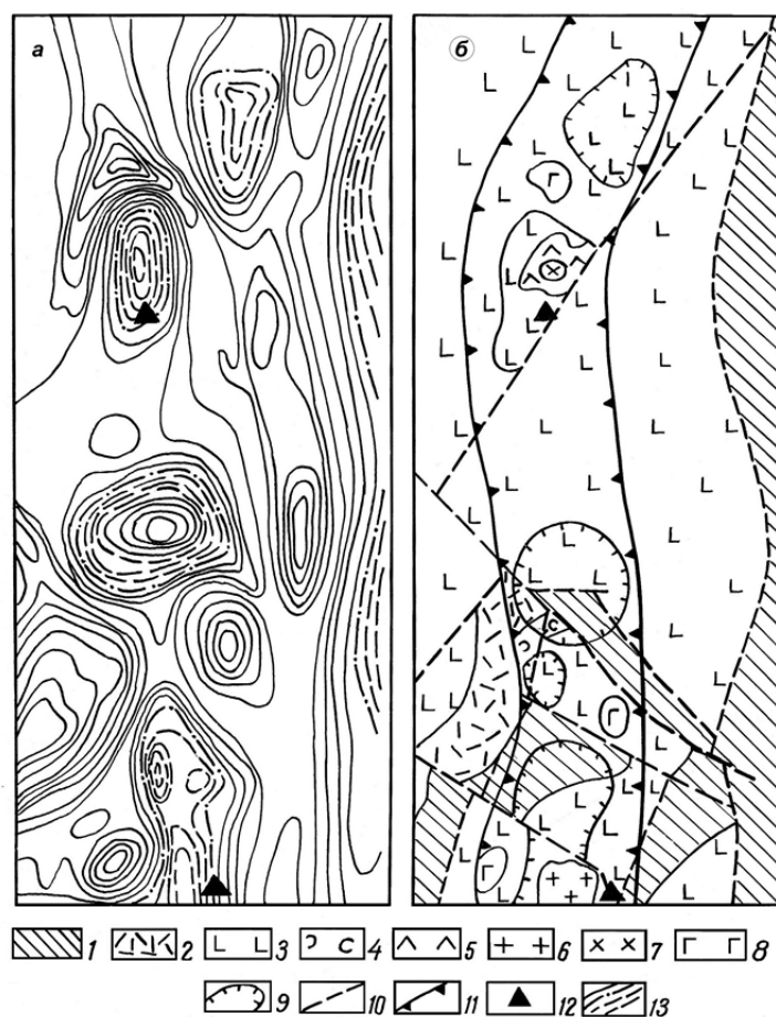
Рис. 5. Выделение региональной рудоконтролирующей структуры геофизическими методами: а – карта локальных аномалий силы тяжести вариаций, R=5 км), б – схема геологического строения с элементами металлогении в восточной части Восточно-Уральского поднятия (по А.М. Виноградову и др.).
