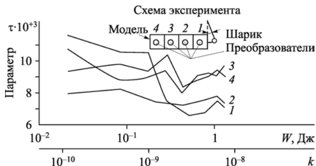
Рис. 8.4. Влияние энергоимпульсного воздействия на спектральную характеристику \tau волновых пакетов.
