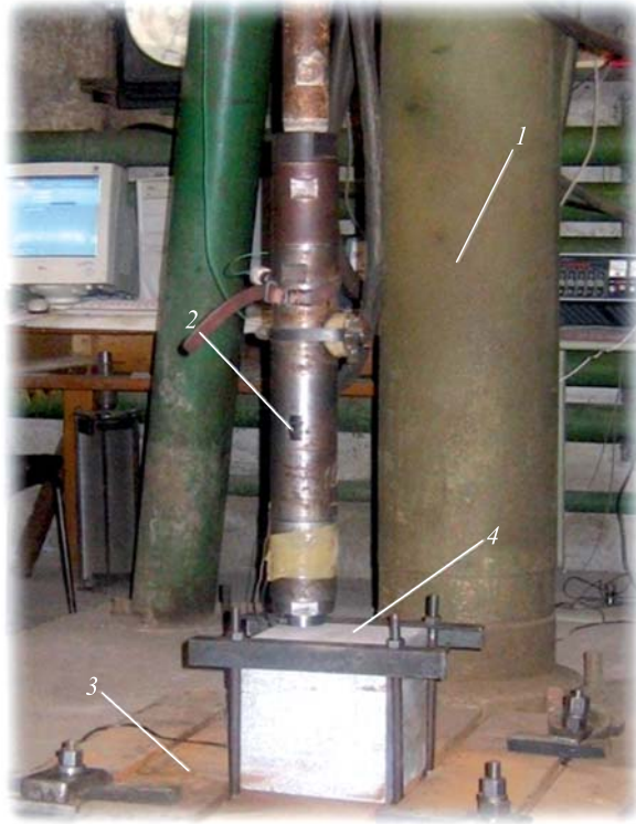
Рис. 8.11. Стенд для исследования породоразрушающего инструмента. Поясн. см. в тексте.
