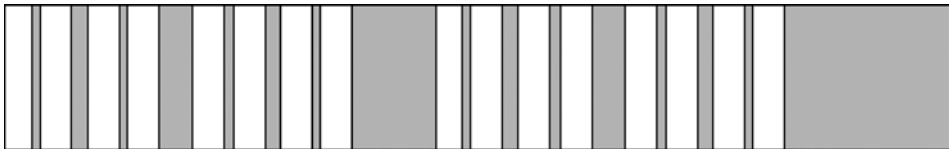
Рис. 10.7. Схематический фрагмент периода иерархической одномерной блочной модели масс (светлые) и прослоек (серые прямоугольники) 16-го порядка.
