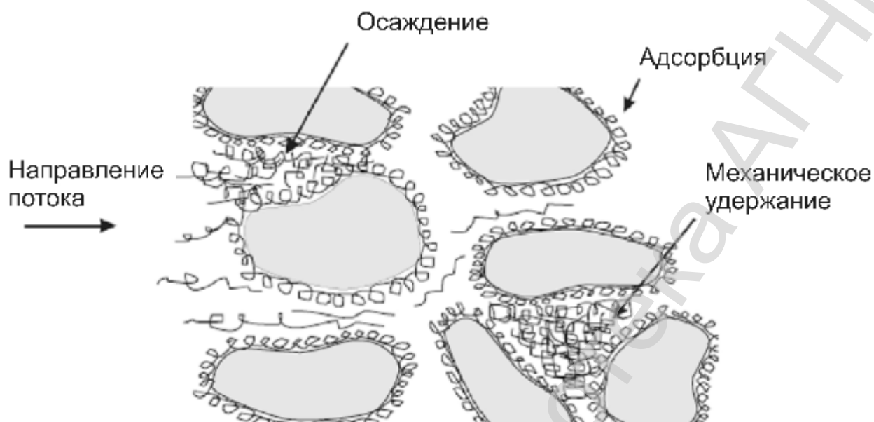
Рис. 17.2 Удержание молекул полимера в пористой среде
