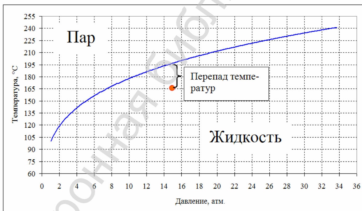
Рис. 20.7 P-T диаграмма воды и иллюстрация концепции поддержания перепада температур
