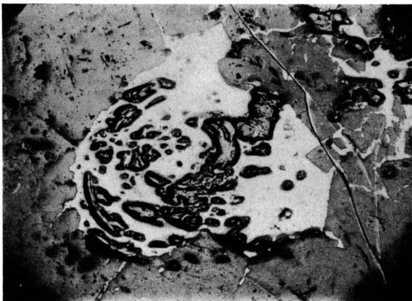
Фиг. 4. Концентрически расположенные зерна касситерита (темносрое) в галените (белое). В отраженном свете, \times 90
