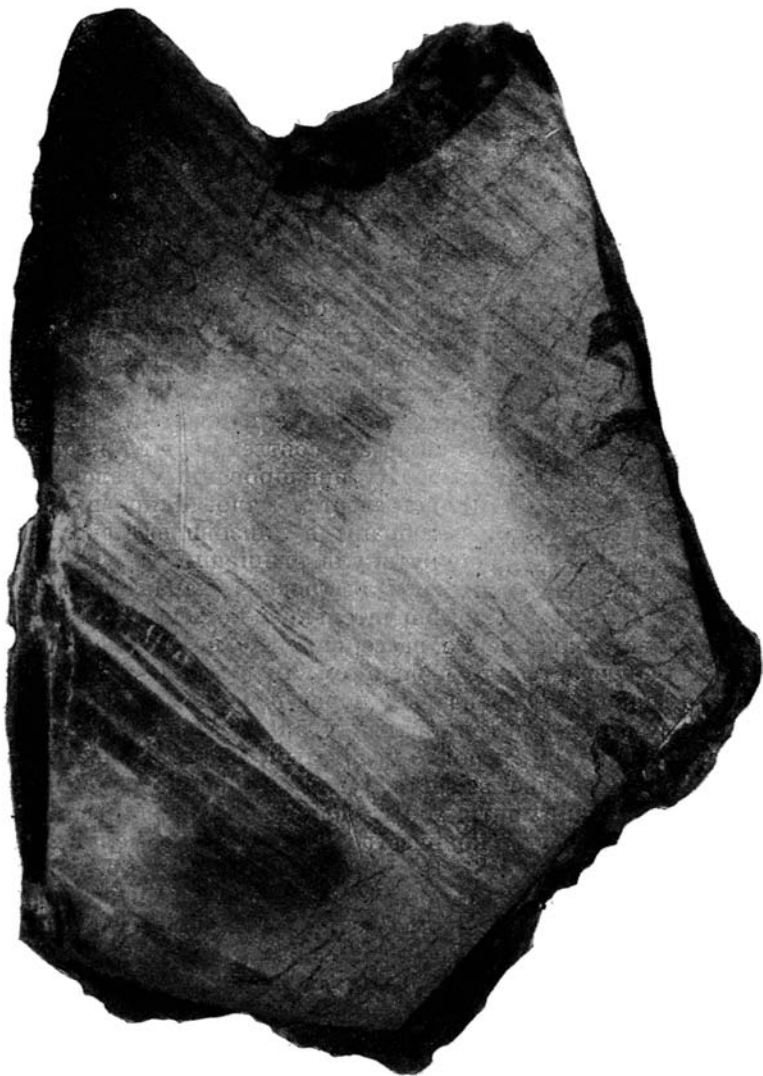
Фиг. 7. Полоса полуматового (малозольного) тонкополосчатого угля в блестящем угле. Байдаевский район. Пласт 16. Нат. вел.
