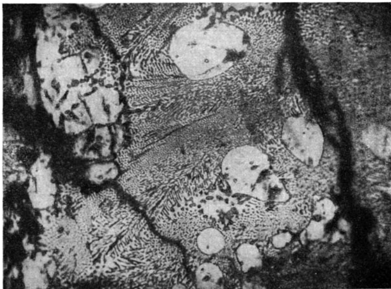
Фиг. 12. Аншлиф сульфидного слоя плавки № 6 табл. 5. Светлые округлые выделения—пирротин, тонкоструктурная часть—эвтектика, состоящая главным образом из FeS и FeO. Увел. 320
