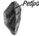
Фиг. 8. Призма размером 1 мм, изготовленная из высокопреломляющего минерала (шеелита); \times 19
