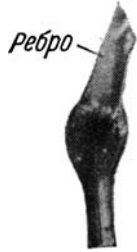
Фиг. 7. Призма размером 1 мм, изготовленная из высокопреломляющего минерала (сфалерита); \times 19
