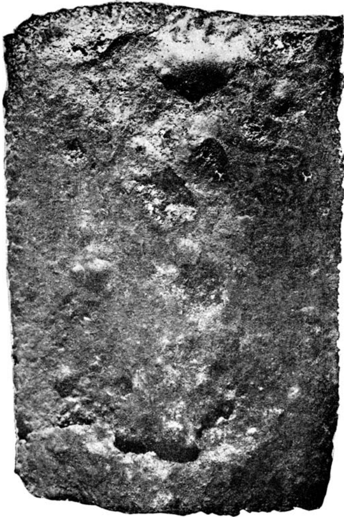
Фиг. 9. Зональный динас с 15-го м. Обр. № 33. Вид на поверхность кирпича, обращенную внутрь печи. Натуральная величина.
