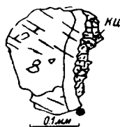
Фиг. 16. Трещины спайности ядра переходят в оболочку, отчасти разъеденную кальцитом. Обр. № 517.
