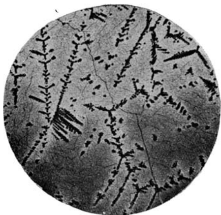
Фиг. 10. Расплав диабаза (обр. № 101), закаленный в воде после выдерживания при 1250^{\circ} в течение 1.5 часа с добавкой 4\% \text{CaF}_2 .
