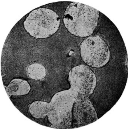
Фиг. 8. Расплав диабазы (обр. № 101), закаленный в воде после выдерживания при 1200^{\circ} в течение 1.5 часа с пропуском \text{NH}_4\text{OH} . \times 42 , николи||.
