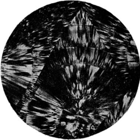
Фиг. 5. Концентрическое нарастание халцедона в секрциях базальта с берега моря у р. Чайдиной. Обр. № 180. \times 25 , николи \perp .
