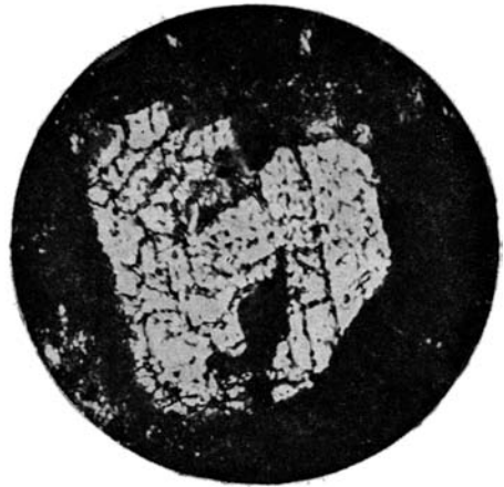
Фиг. 5. Зональный динас с 10-го м. Обр. № 29. Переходная зона. Ув. 240. Свет поляризованный.
