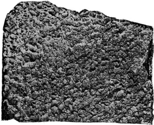
Фиг. 2. Зональный дуннас с 5-го м. Обр. № 27. Вид на поверхность кирпича, обращенную внутрь печи. Ум. 1.5.
