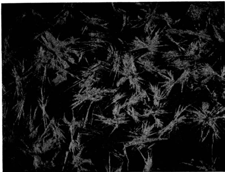
Фиг. 24. Спутанно-пластинчатый агрегат ковеллина. Полир. шлиф, ув. 140.
