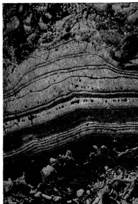
Фиг. 7. Зонально-полосчатый агрегат мельниковита-пирита-марказита. Полир. шлиф, ув. 46.
