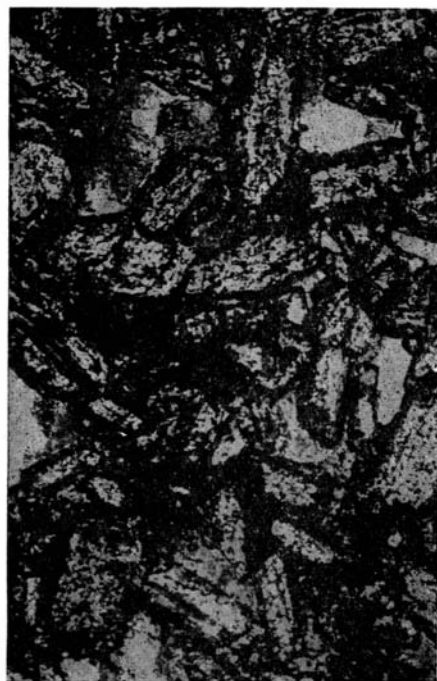
Фиг. 41а. Распределение окислов железа между зернами ярозита. Прозрачный шлиф, ув. 95.
