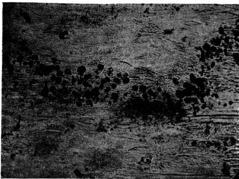
Фиг. 25. Округлые частицы новообразований дисульфида железа (черное) в гипсе. Прозрачный шлиф, ув. 280.
