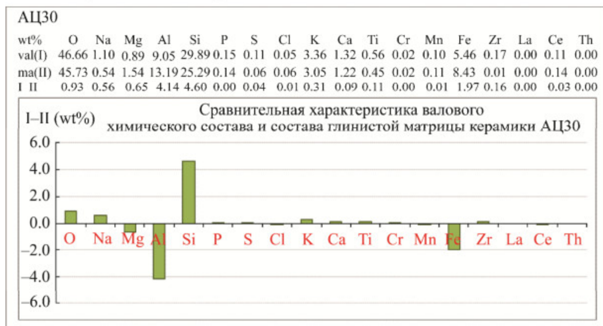
Рис. 6.6. Сравнение валового химического состава (val) керамики АЦ30 с химическим составом матрицы (ma), wt% – мас. % элементов
