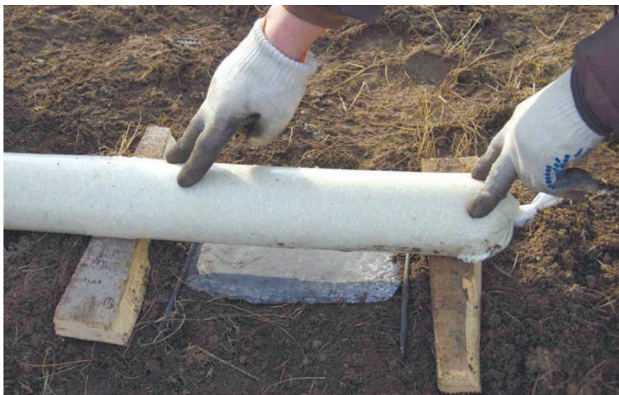
Рис. 3.6. Расположение заряда ВВ относительно пластины-свидетеля.
