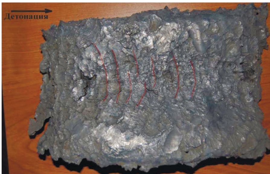
Рис. 3.9. Пластина-свидетель после взрыва. Красным цветом отмечены бороздки.
