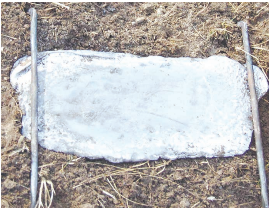
Рис. 3.5. Свинцовая пластинка (длина x ширина x толщина – 220 x 150 x 12 мм), зафиксированная скобами на песчаной подушке.
