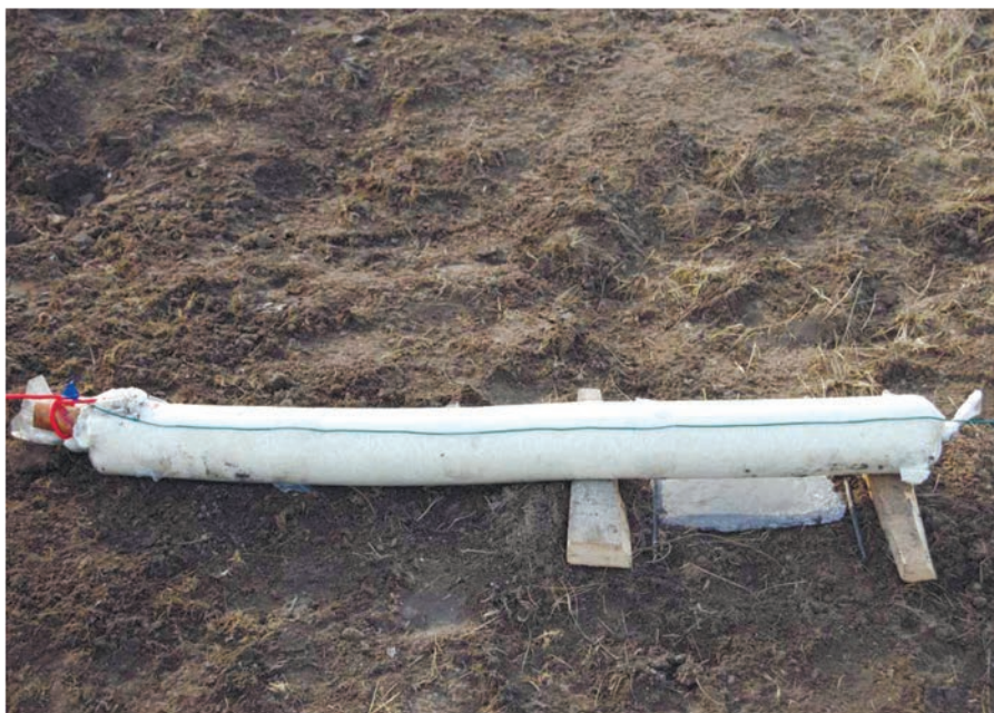
Рис. 3.7. Расположение заряда ВВ с пластиной-свидетелем в плане.
