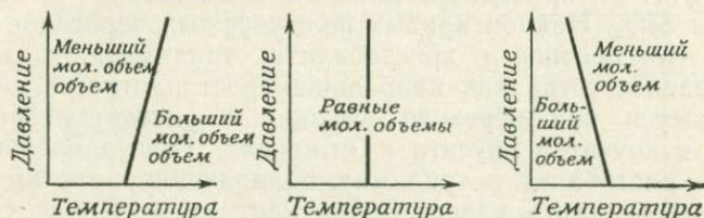
Фиг. 96. Влияние различия молекулярных объемов двух полиморфных модификаций на положение кривой перехода.
