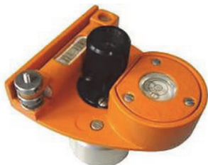
Рис. 1.18. Вид цилиндрического и круглого уровней
