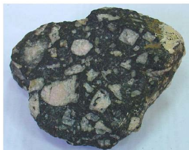
Рис. 9. Структуры по относительным размерам кристаллов: a – равномерно-зернистая; б – собственно неравномерно-зернистая (порфировидная); в – порфировая
