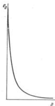
Рис. 11. Компрессионная кривая слабого грунта
