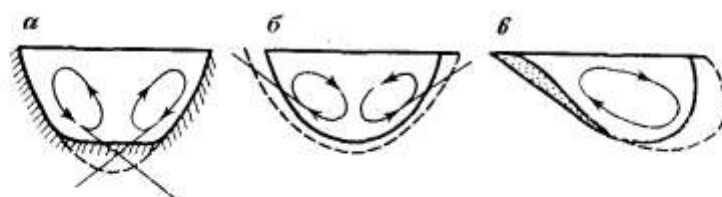
Рис. 61. Эрозионная деятельность сбойных течений в русле реки: а — размыв дна; б — расширение русла; в — односторонний подмыв берегов
