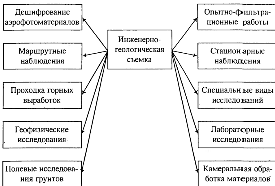
Рис. 1. Полевые, лабораторные и камеральные работы в составе инженерно-геологической съёмки
