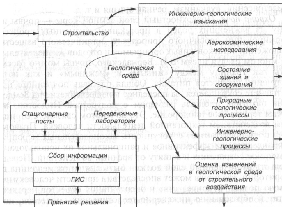
Рис. 28. Функциональная схема геоинформационной системы оценки влияния строительства на геологическую среду
