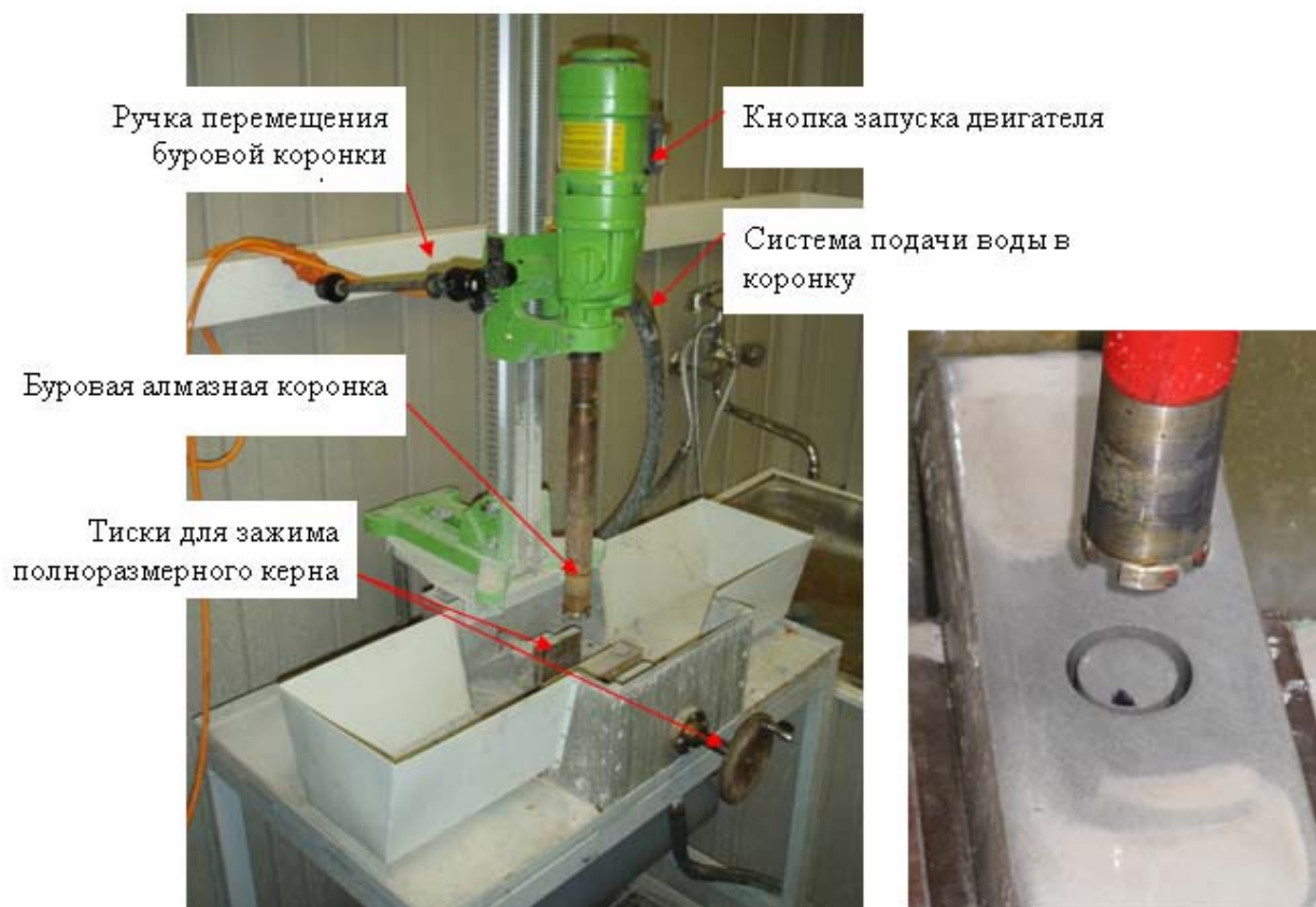
Рис.7.9 Станок для высверливания цилиндрических образцов
