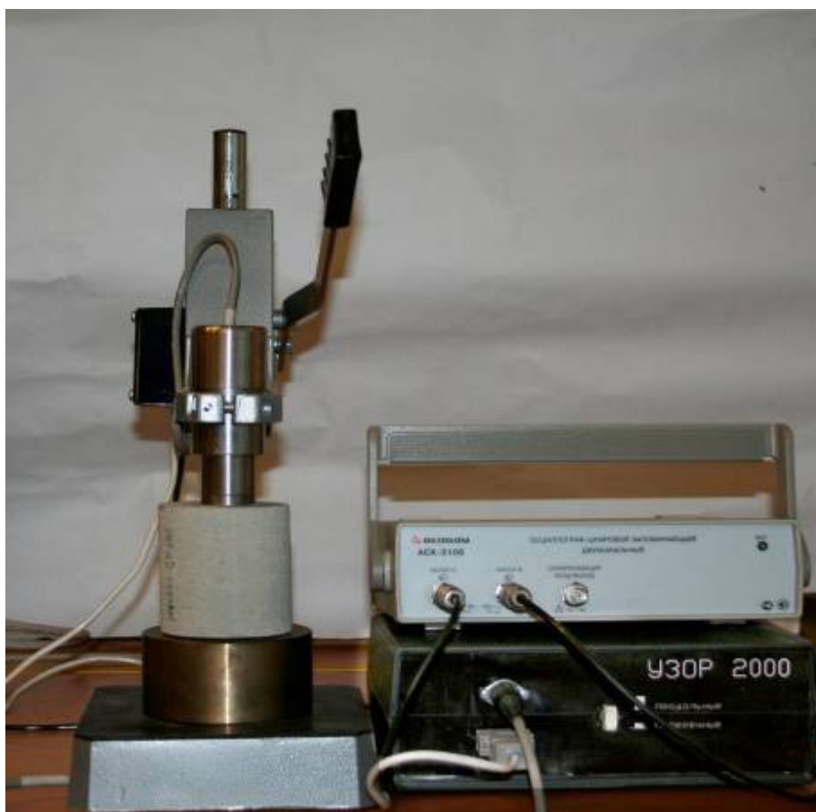
Рис. 8.1 Общий вид прибора «УЗОР 2000» для определения скорости распространения упругих продольных и поперечных акустических волн
