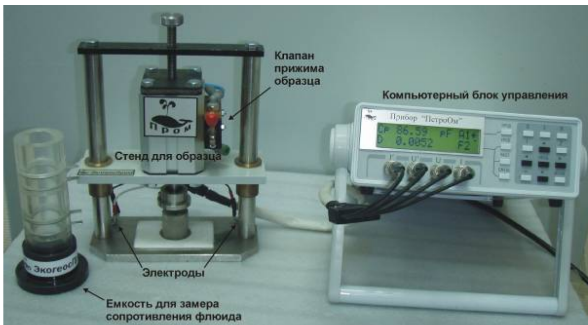
Рис. 7.1 Прибор для определения УЭС горных пород и флюидов «ПетроОм»
