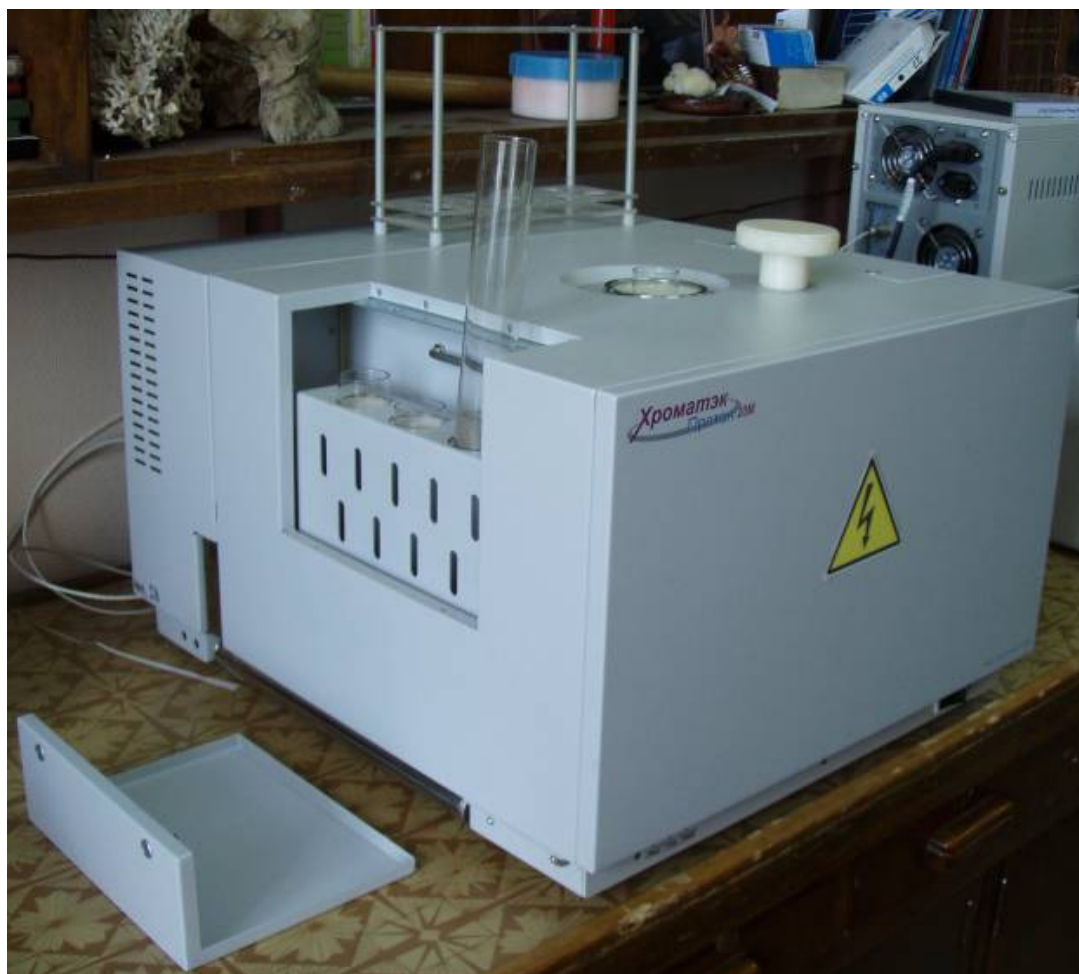
Рис. 10-8 Блок магнитный аппаратуры «ХРОМАТЭК-ПРОТОН 20М»
