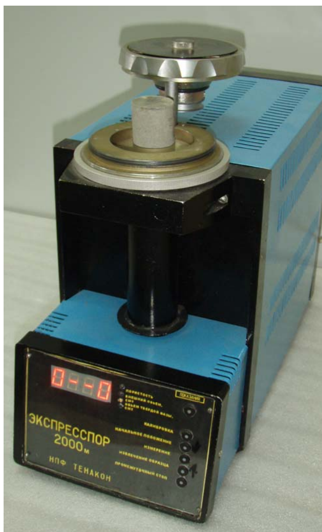
Рис. 1.1 Газовый порозиметр «Экспресспор-2000»
