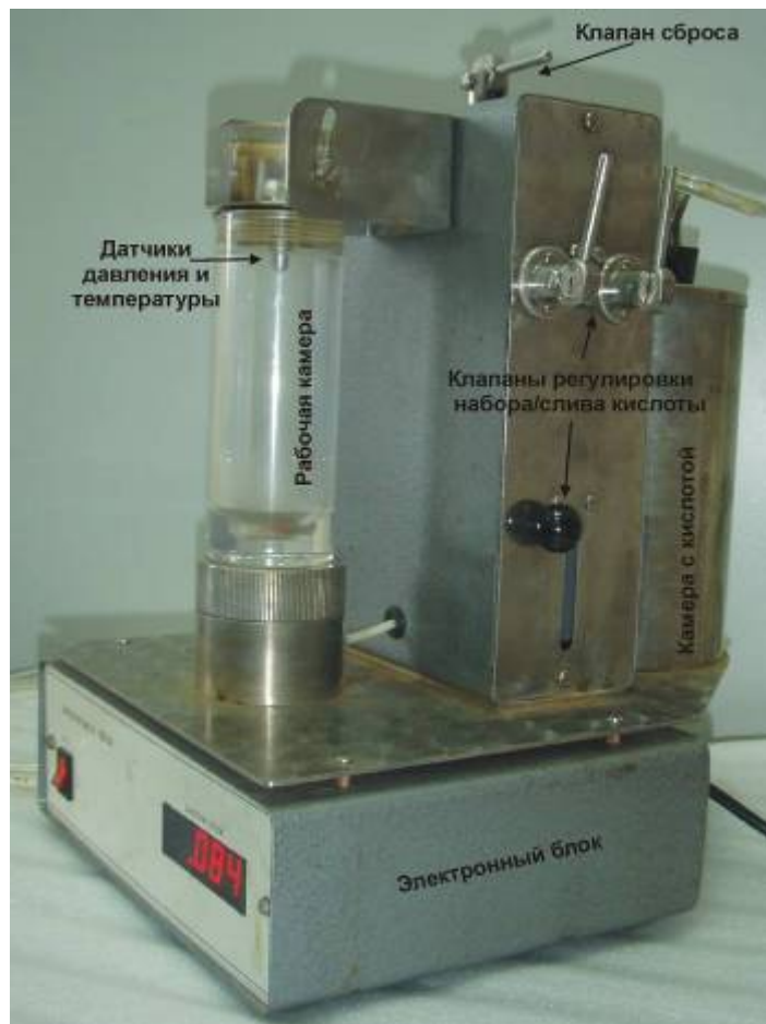
Рис. 6.1 Общий вид прибора «Карбонатометр КМ-04»
