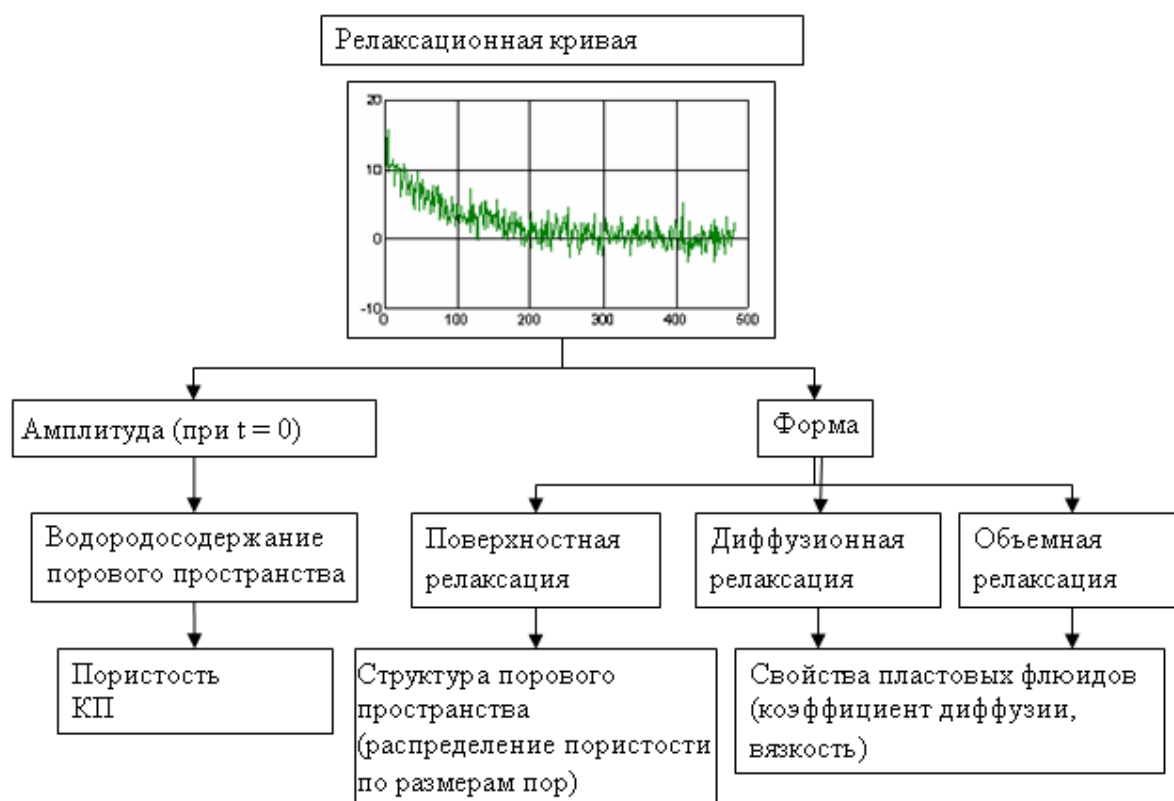
Рис. 10-4 Основные факторы, влияющие на регистрируемый сигнал при ЯМР-исследованиях
