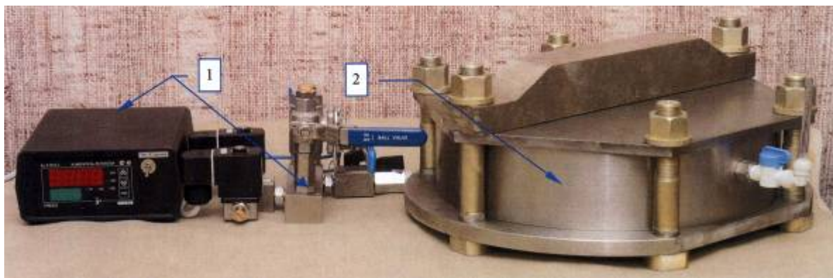
Рис. 4.1 Общий вид установки УГК-1. 1-блок регулировки давления газа, 2-капилляриметр
