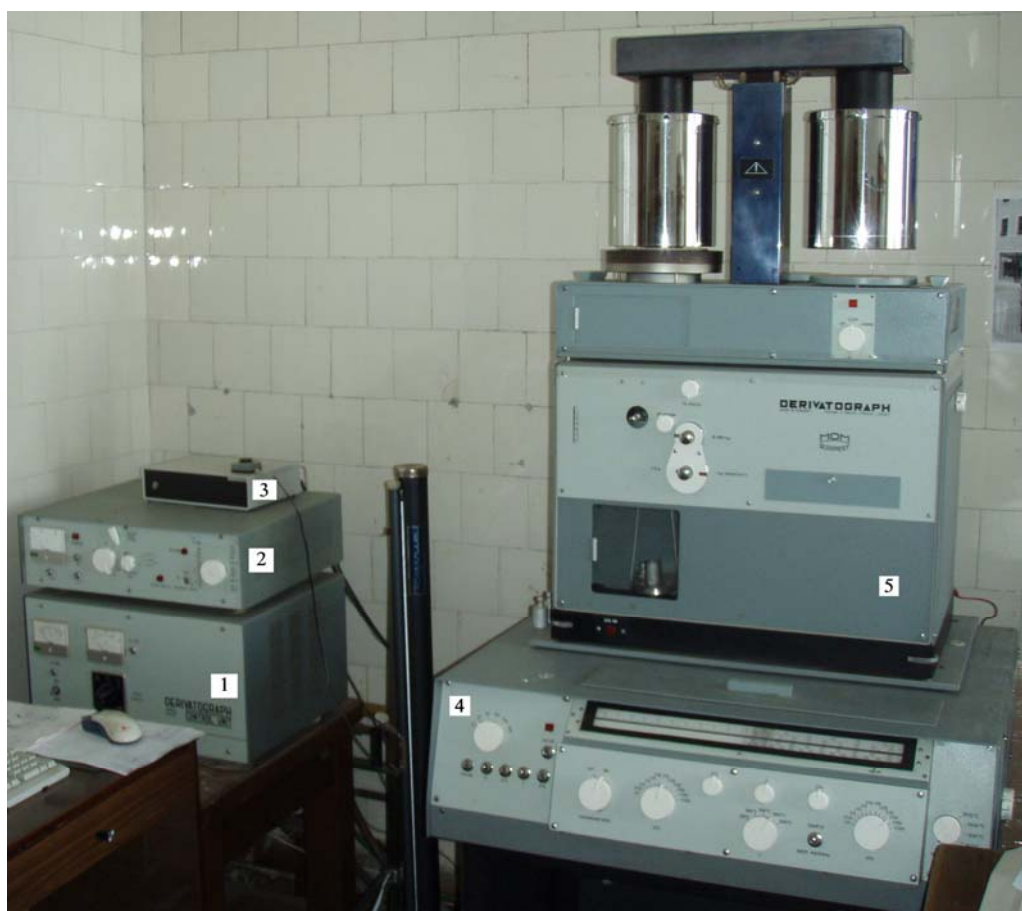
Рис. 11.3 Общий вид аппаратуры «Derivatograf» 1,2 - блоки питания и регулятора напряжения, 3 – блок связи с компьютером, 4 – блок гальванометров, 5 - измерительный блок
