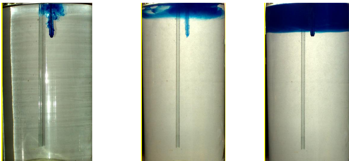
Рис. 1. Этапы верхней подачи пресного растворителя в насыщенный рассол
