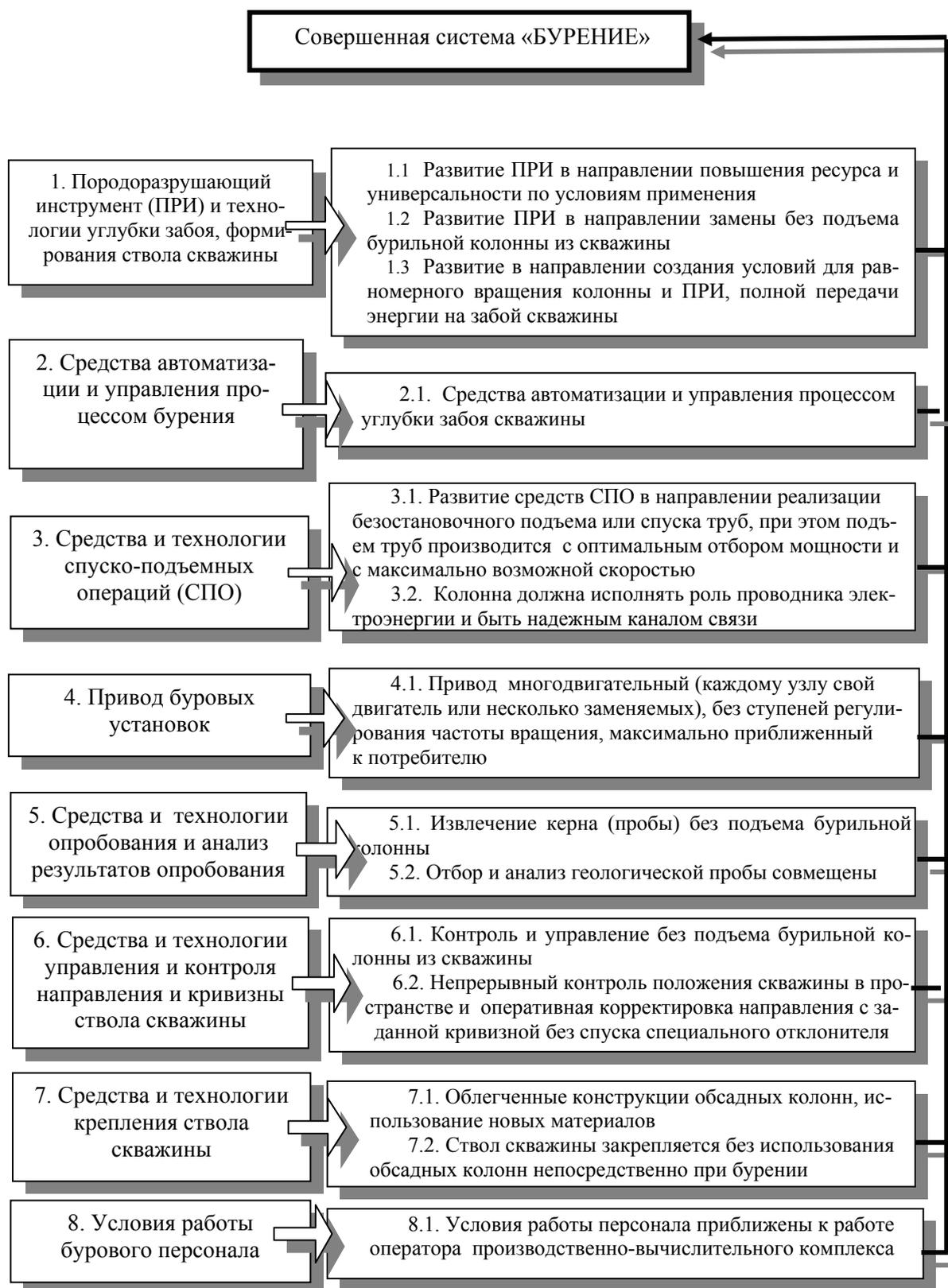
Рис. 3.2. Структурная схема развития технической системы «Бурение»
