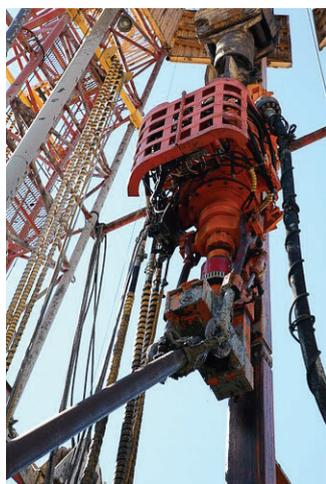
Рис. 3.17. Верхний привод буровой установки глубокого бурения
