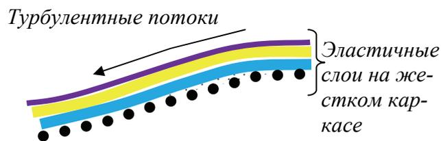
Рис. 2.19. Слоистая структура обшивки рабочего элемента
