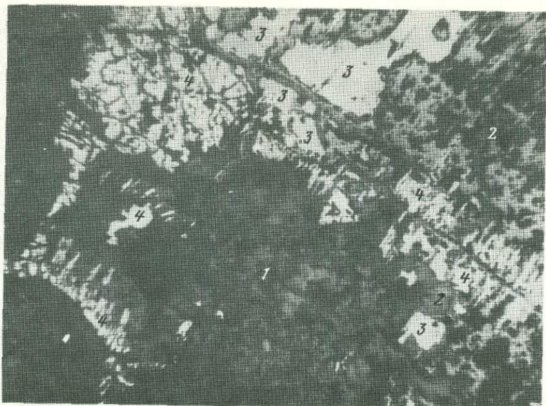
Р и с. 11. Структура замещения пирротина (3) валлериитом (1) и магнетитом (2) с сохранением пламенеобразных выделений пентландита (4) Талнахское месторождение. Полированный шлиф. x85
