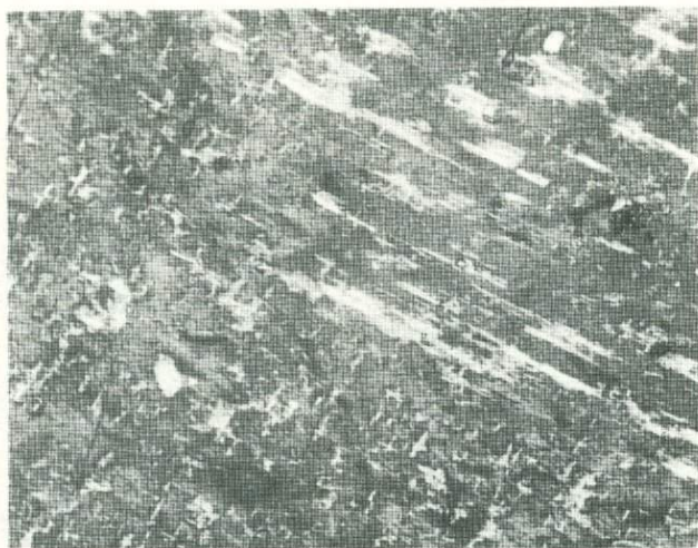
Р и с. 6. Микроструктура пертитового полевого шпата из эндоконтактового рихсчоррита. Реликт микропертита (справа сверху) в криптопертите со следами перетложения альбитовой фазы
