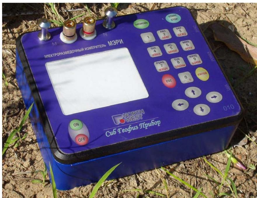
Рис. 3. Многофункциональный электроразведочный измеритель «МЭРИ-24».
