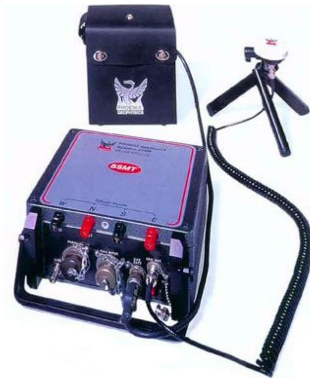
Рис. 1. Электроразведочная станция МТУ-5А.
