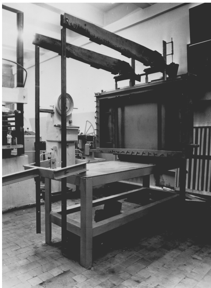
Рис. 11.2. Общий вид плоского стенда для моделирования на эквивалентных материалах (Национальный горный университет)
