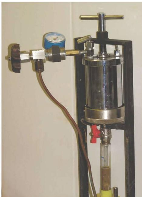
**Рис. 4.2. Схема испытательной установки для моделирования проницаемых кернов**
