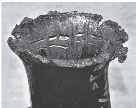
**Рис. 5.2. Насосно-компрессорная труба, разрезанная кумулятивной труборезкой**
