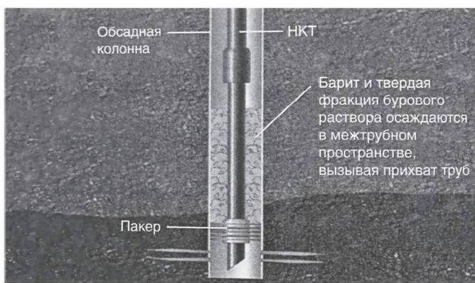
**Рис. 5.7.** Прихват, связанный с качеством бурового раствора
